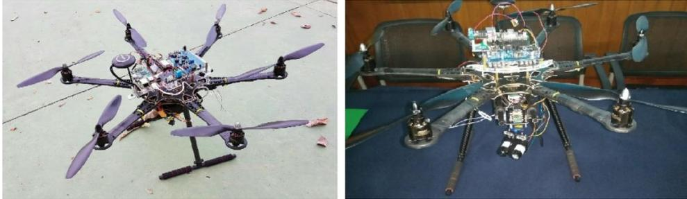
*Figura 34. Dron Optimizado con Dispositivo de Medición de Radiación Ionizante.*
