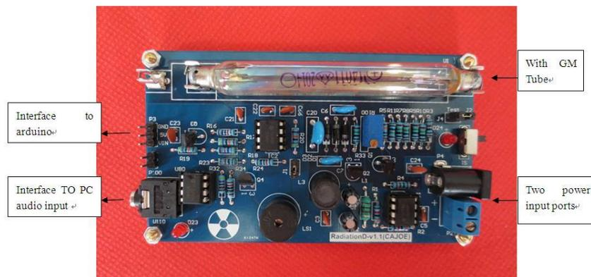
**Figura 16. Contador Geiger Müller modelo NGMC-V1**
