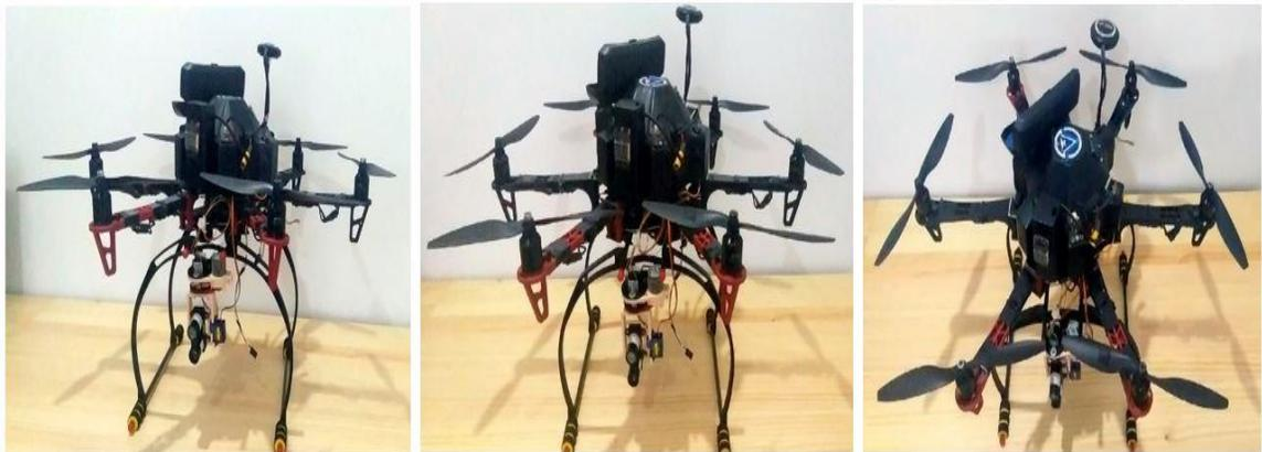
***Figura 36. Dron Optimizado para Dosimetría Ambiental.***
