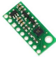
***Figura 12. Medidor de presión y altitud LPS331AP***
