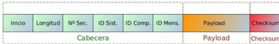
**Figura 24. Estructura de un paquete MavLink**
