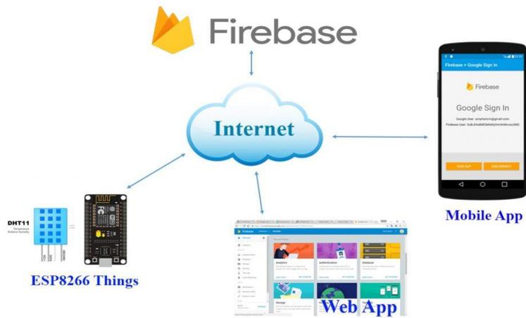
**Figura 28. Ejemplo de diagrama de sistema datos de Medidor a FireBase**
