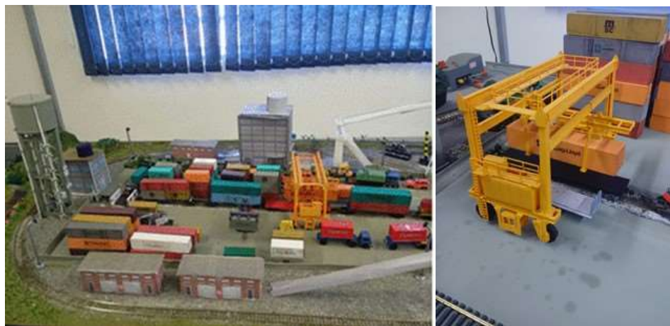
Figura 7.31 — Terminal de contêineres, à esquerda detalhe do transtainer .
